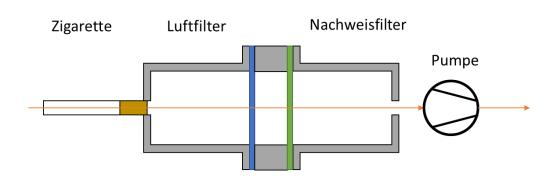
**Funktionsprinzip:** Durch die Pumpe wird permanent Luft durch die brennende
